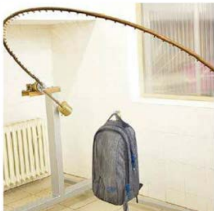
Zkušební zařízení prověřovalo odolnost batohů proti lehkému dešti.
